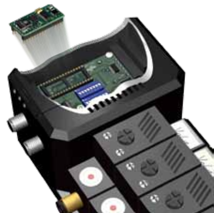
Anybus-ICの搭載例です。 バルブターミナルのDeviceNetの対応を実現しています。
