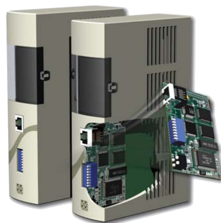
Anybus-SEthernet基板がモーションコントローラに組み込まれています。
